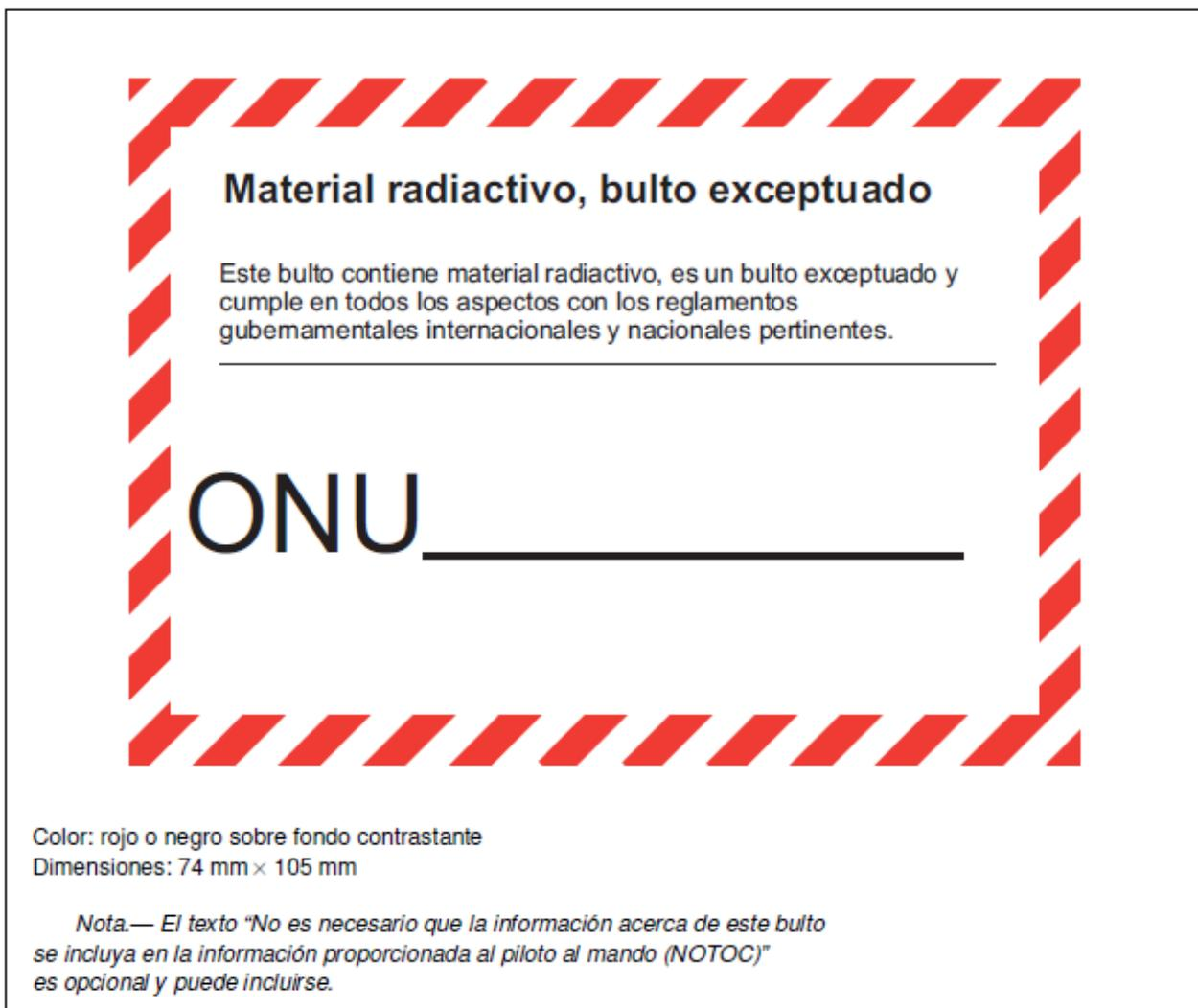
Figura 1.28. Material radiactivo, bulto exceptuado
