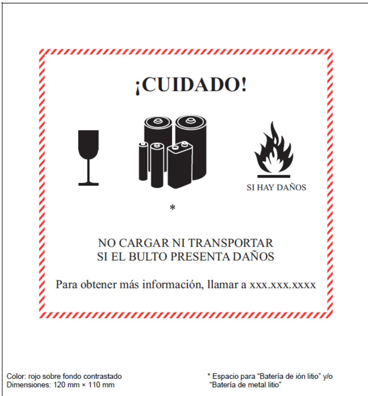
Figura 1.29. Etiqueta de manipulación de baterías de litio
